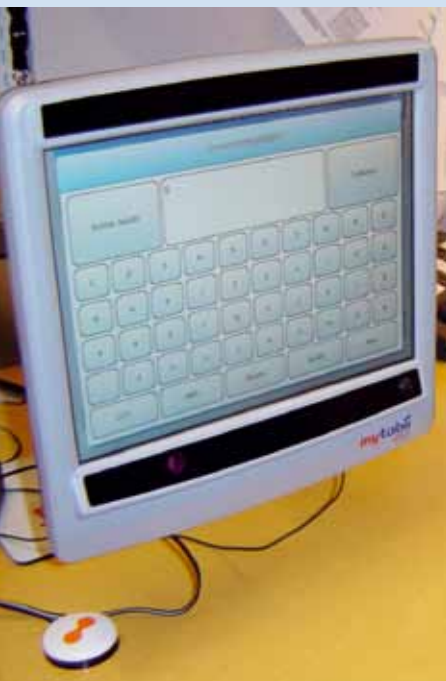
Tietokone, jossa on sisäänrakennettu katseohjauslaite. ▼
