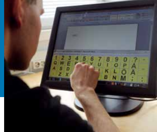
Tietokoneen ruutunäppäimistöohjelma ja kosketusvaruuntu kirjoittamisen apuvälineenä.
